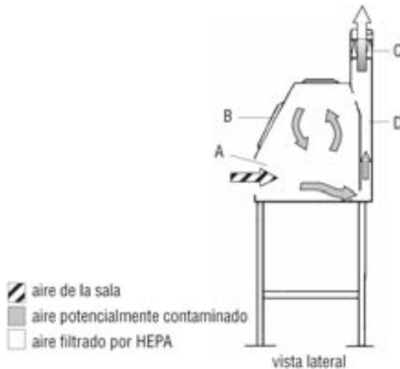
Figura 6. Esquema de una cámara de seguridad biológica de clase I. A: abertura frontal; B: ventana de cristal; C: filtro HEPA de salida; D: cámara de distribución del extractor
